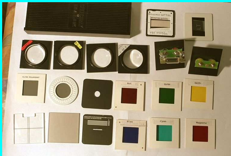
Alle Komponente: Rillenkasten, Strichgitter, Linsen, Farb- und Polarisationsfilter, Akrylglas- und Mattscheibe, Blenden, Lampe, Fotozelle.
