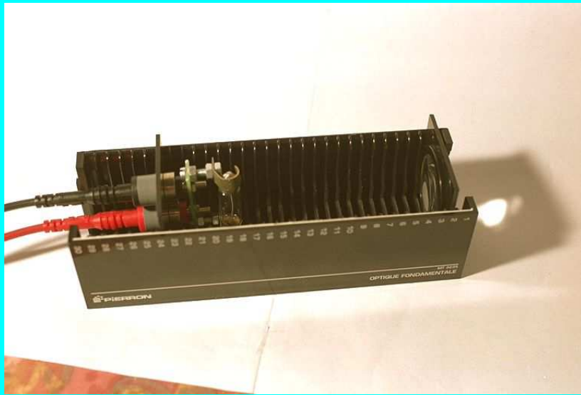
Der Rillenkasten Die Lampe im Brennpunkt der Linse erzeugt ein paralleles Lichtbündel
